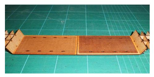
Die beiden Tieflader Plattformen werden ausgewuchtet mit den Stirnseiten und in Stelle geklebt.
