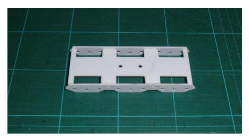
Die Drehgestell-Seitenwände werden in Harz abgegossen, entgratet, und an die Hinterseite eingebohrt für die Gleitlager.
