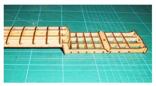
Weitere Verstärkungsplatten werden eingeklebt für das Drehgestell Drehpunkt an die Oberseite.
