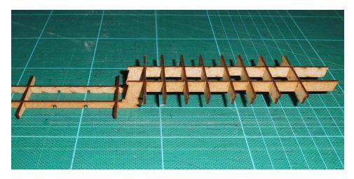
Weitere Plattform Querträger vom Tiefladeboden werden eingeklebt, auf die Längsträgern, auch die auf geklippte.
