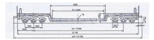
Aus diesen ersten Zeichnungen (mit Hauptabmessungen) wird die Konzept Zeichnung entwickelt, worauf jedem Teil in Materialart und Dicke festgelegt wird, um separat auszuschneiden oder anzufertigen.
