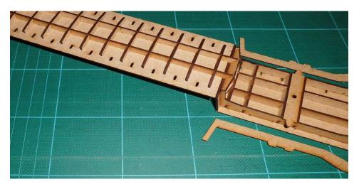
Für den Tiefladeboden werden MDF Streifen als Hilfsträger eingeklebt.
